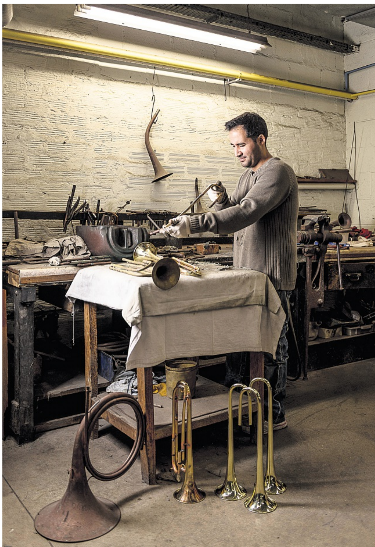
Julien Mocci soude et assemble les trompettes, à Etampes-sur-Marne, le 2 novembre. ERIC GARAUULT/PASCOANDCO POUR « LE MONDE »
