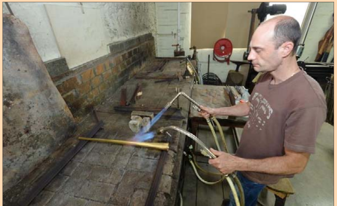
Le pavillon est plié autour d'une forme puis soudé au chalumeau. On écrase ensuite la soudure avec un mandrin. Puis, on chauffe le métal pour l'attendrir afin de passer sur un banc à étirer afin de porter la pièce à la cote exacte.
