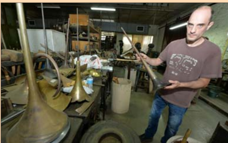
La collerette est fabriquée à partir d'un disque qui passe par plusieurs formes successives. Au cours du travail, la pièce est « repoussée » avec un mandrin sur un tour. On finalise la bordure après y avoir enfilé un fil de fer. Le pavillon est enfin emboîté et soudé.
