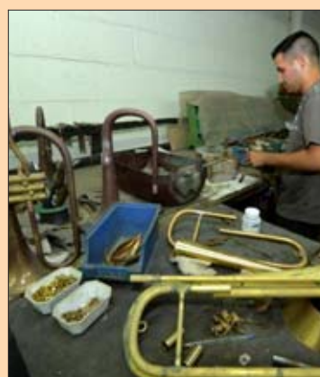
Rempli de résine de pin pour ne pas être écrasé, le pavillon est cintré autour de pièces en bois pour recevoir sa forme définitive. On soude les pièces nécessaires à l'étain.
