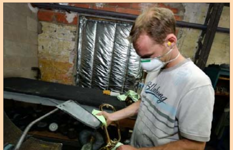
La dernière étape est celle du polissage. Le vernissage n'est pas systématique et se fait à la demande du client.
