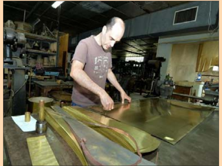
Pour fabriquer un clairon basse, Stéphane Glace, chef d'atelier, chaudronnier et pistonnier, part d'une feuille de métal d'une épaisseur d'un demi-millimètre qu'il découpe autour d'un patron. Couesnon travaille essentiellement le laiton, un peu le cuivre et le maillechort apprécié pour sa couleur blanche.
